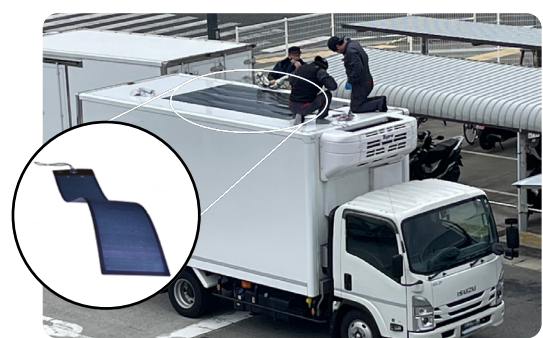
太陽光発電搭載トラックの実証実験
